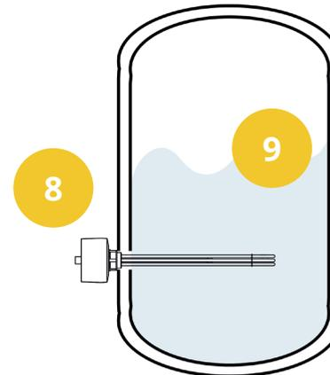
**Warnung!** Der Heizstab muss vollständig von Wasser umgeben sein und darf unter keinen Umständen im Trockenbetrieb genutzt werden.
