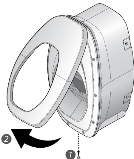
1. Entfernen Sie die Schraube an der Unterseite der vorderen Abdeckung mit einem Torx-T20-Schraubendreher.
