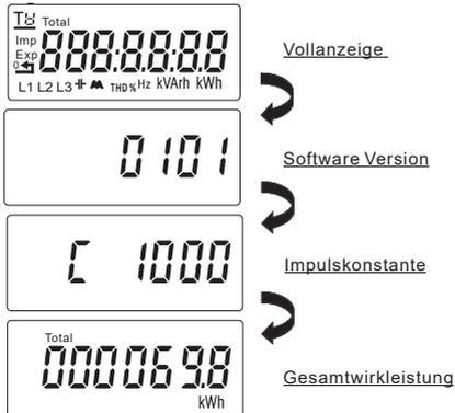
Die Standardanzeige beim SDM72D, SDM72DR und SDM72BiS ist die Gesamtwirkenergie (kWh), je nach Berechnungsmethode.
