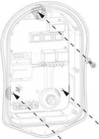
Wenn Sie das mitgelieferte Befestigungskit zur Wand-Befestigung verwenden, stellen Sie sicher, dass die Schutzart **IP 65** erhalten bleibt. (Hinweis: wenn Sie die rückseitige Kabeleinführung nutzen, sollten Sie das Netzkabel vorher in die Wandbefestigung einbringen.)
