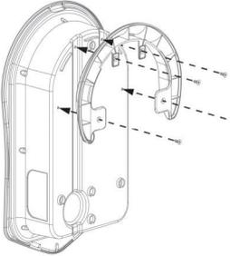
Wenn Sie ein zappi mit Ladekabel (tethered) installieren, muss das Kabel-Wand-Schutz-Formteil mit den 4 mitgelieferten Schrauben M4 x 12mm am Gehäuse verschraubt werden.
