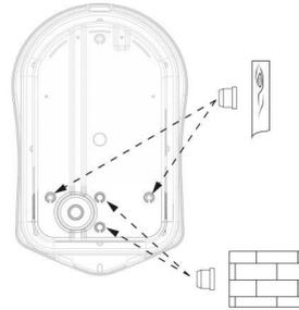
Um die Schutzart **IP 65** zu gewährleisten, verschließen Sie alle nichtbenötigten Kabeleinführungen oder Bohrlöcher mit den mitgelieferten oder im Handel erhältlichen Stopfen.
