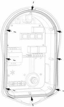
**Stellen Sie sicher, dass der Dichting vor dem Verschließen des Gehäuses korrekt in seiner Führungsnut liegt.**
