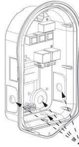
Für die Stromversorgung haben Sie 4 alternative Kabeleinführungen zur Verfügung. Prüfen Sie, welche davon gem. obiger Abbildung für Sie baulich am günstigsten ist. Sie benötigen eine Kabelverschraubung nach **IP 65 oder höher**.
